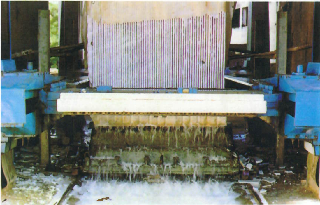
Foto 1.4 - Tear multilâminas utilizado na serragem do bloco no beneficiamento. (Vista frontal)
